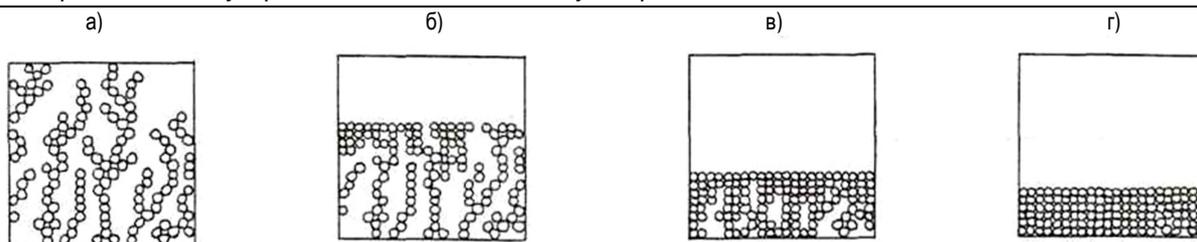
Рис. 1. Схема процесса переуплотнения частиц: а) начальное состояние с относительной плотностью  $\theta = 0,11-0,45$  (1,4–1,75 г/см<sup>3</sup>); б)  $\theta = 0,25-0,55$  (1,8–2,00 г/см<sup>3</sup>); в)  $\theta = 0,55-0,85$  (1,95–2,25 г/см<sup>3</sup>); г)  $\theta = 0,65-0,95$  (2,2–2,6 г/см<sup>3</sup>)
