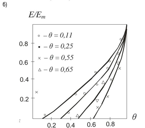
Рис. 5. Графики зависимости плотности грунта от давления (а) и модуля упругости от давления (б)
