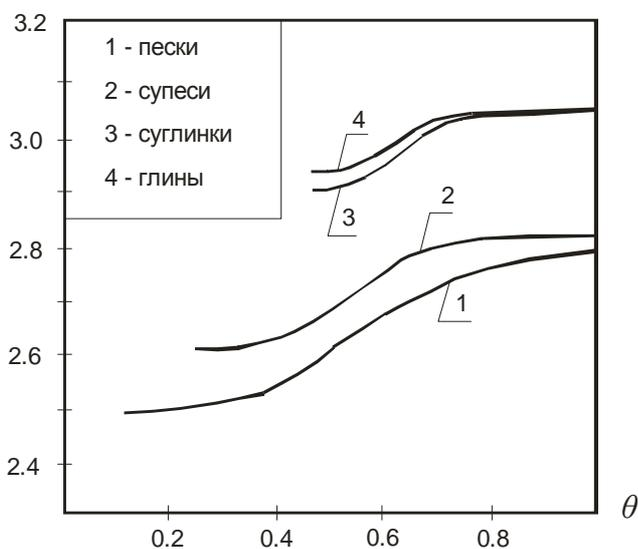
Рис. 2. Зависимость фрактальной размерности от относительной плотности грунтов
