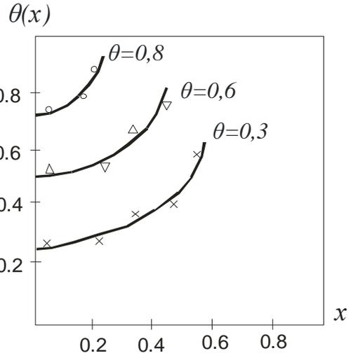
Рис. 3. Распределение критических контактных сечений (а) и относительной плотности грунтового массива на разных стадиях уплотнения при  $\theta = 0,22$
