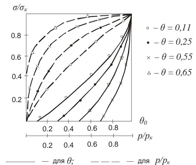
Рис. 6. Графики зависимости относительной прочности грунта от формируемой плотности  $\theta$  и относительного давления  $p / p_k$
