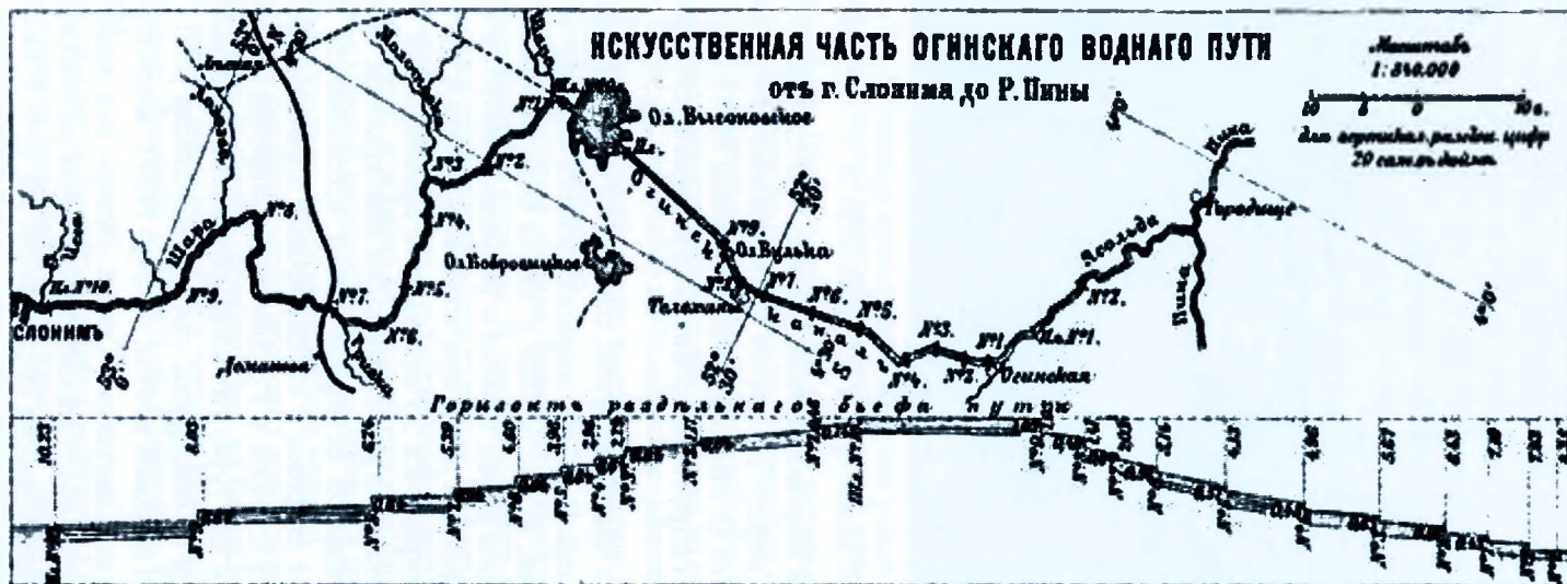
Рис. 5.11. План и продольный профиль Огинского канала. Конец XIX в.
