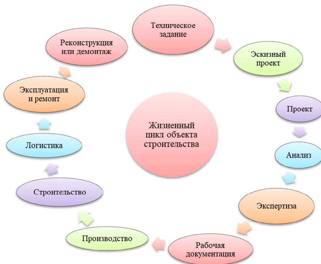
Рисунок 3 – Жизненный цикл объекта строительства
