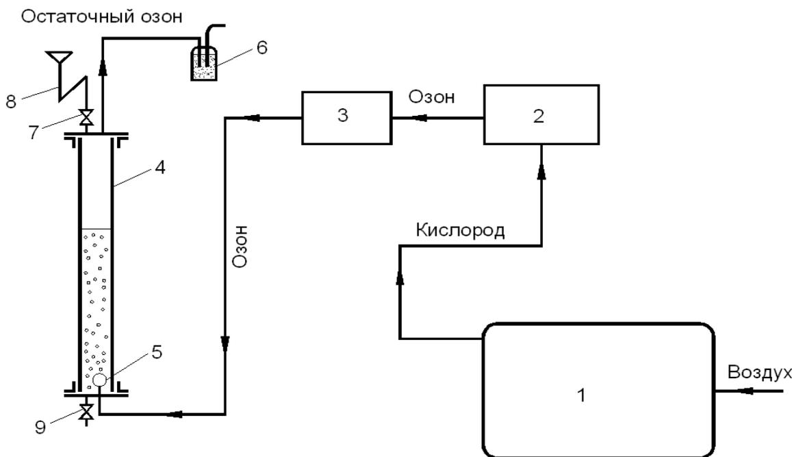
1 – концентратор кислорода *Atmung oxy 6000*; 2 – озонатор *PLATON 10/2*;
