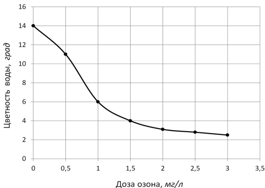
*Рисунок 2 – Цветность воды после обработки различными дозами озона*
