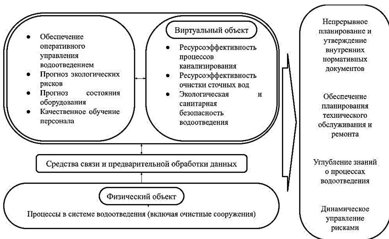
Рисунок 1 – Структура цифровых двойников систем водоотведения коммунально-промышленных объектов
