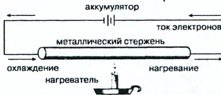
Рисунок 2 – Схема наблюдения эффекта Томсона
