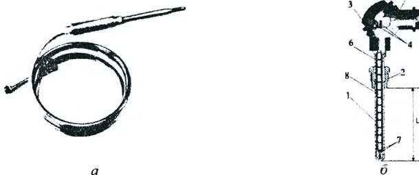
1 – защитная гильза, 2 – штуцер, 3 – головка, 4 – розетка, 5 – патрбук, 6 – трубка. 7 – термоэлектроды, 8 – погружаема часть длиной L
