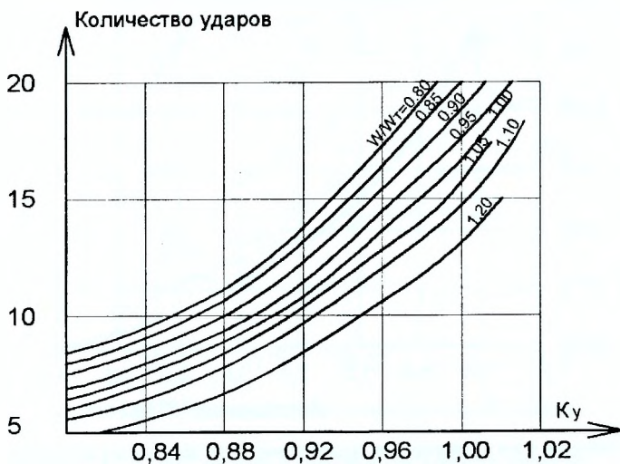
Рисунок 4.8.2 – График для определения коэффициента уплотнения супесей
