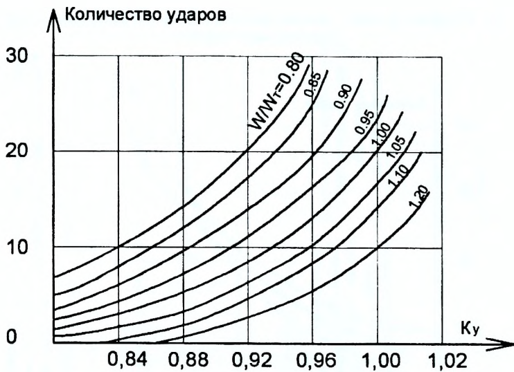
Рисунок 4.8.3 – График для определения коэффициента уплотнения суглинков
