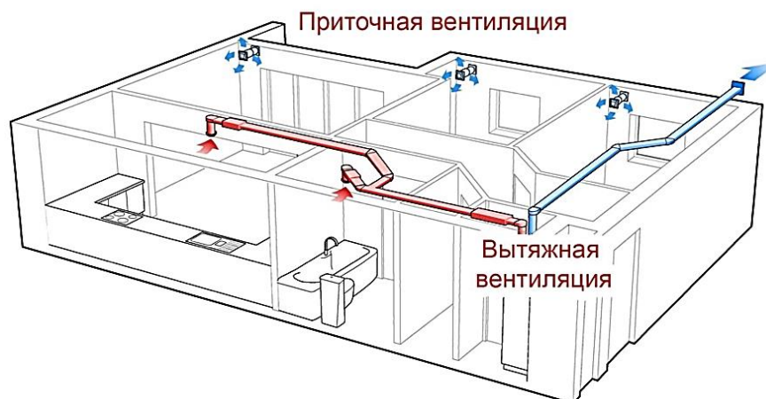
Рисунок 1. Расположение приточно-вытяжной вентиляции.
