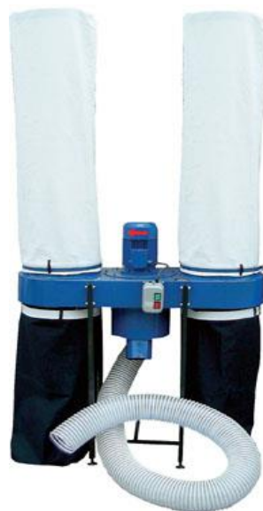
Рисунок 3. Конструкция пылеулавливающей системы с двумя рукавами.
