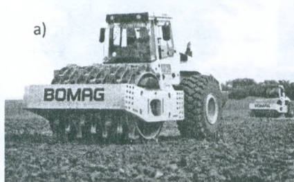
Рисунок 26.4 – Самоходный – а и прицепной – б кулачковые катки
