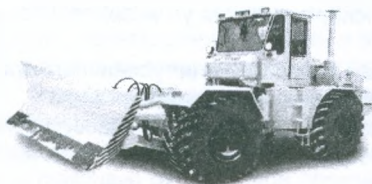
Рисунок 22.4 – Колесный бульдозер K-702MBA-01-БКУ (170 кВт)
