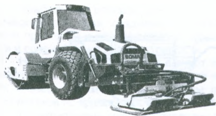
Рисунок 26.5 – Грунтовые катки с виброплитами Bomagrus
