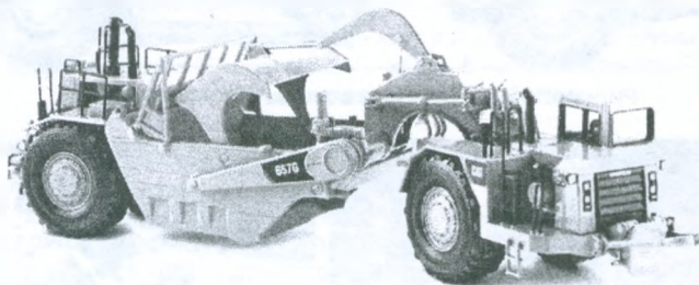
Рисунок 21.4 – Скрепер Cat 657G
