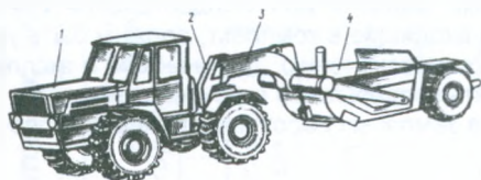
1 – трактор; 2 – седельно-сцепное устройство; 3 – рама; 4 – ковш с заслонкой и задней стенкой Рисунок 21.2 – Самоходные трехосные скреперы
