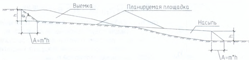
Рисунок 28.10 – Схема к определению заложения откосов
