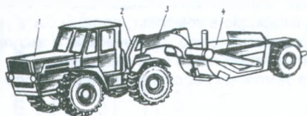
1 – трактор; 2 – седельно-сцепное устройство; 3 – рама; 4 – ковш с заслонкой и задней стенкой Рисунок 21.2 – Самоходные трехосные скреперы
