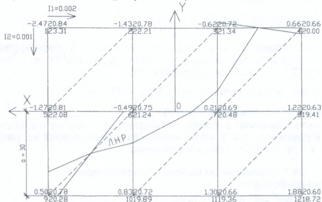
Рисунок 28.4 – Схема к определению красных, рабочих отметок и построению л.н.р.
