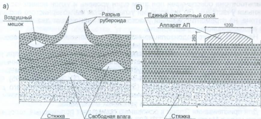
Рис. 27. Ремонт водоизоляционного ковра с помощью прогрева термоэлектрическим аппаратом марки АП
