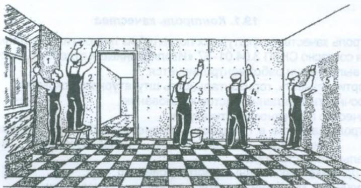
Рис. 49. Последовательность отделки стен помещений листами сухой штукатурки
