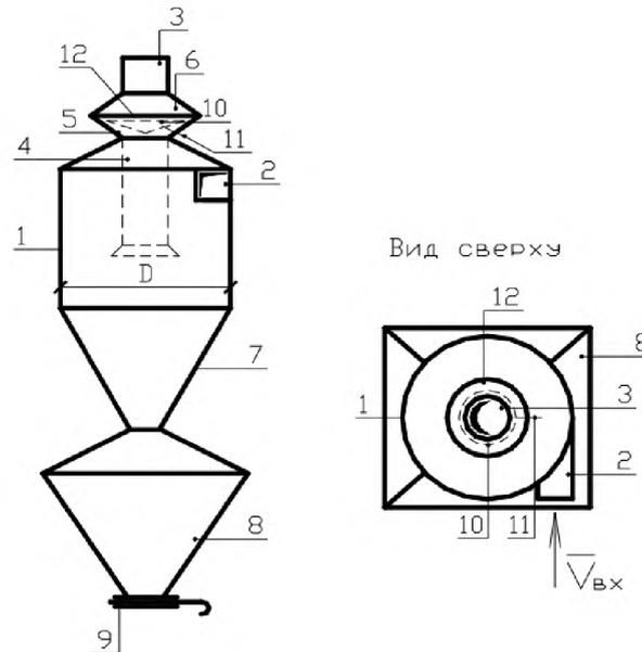
Рисунок 3 – Циклон серии К:
