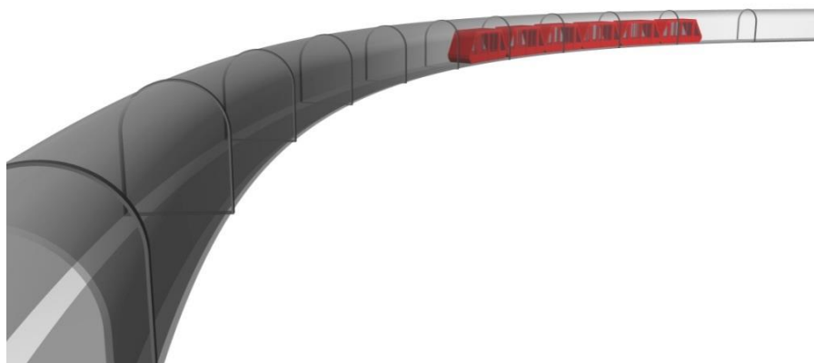
Рисунок 7.4 – Кассета из шести инфобусов в тоннеле
