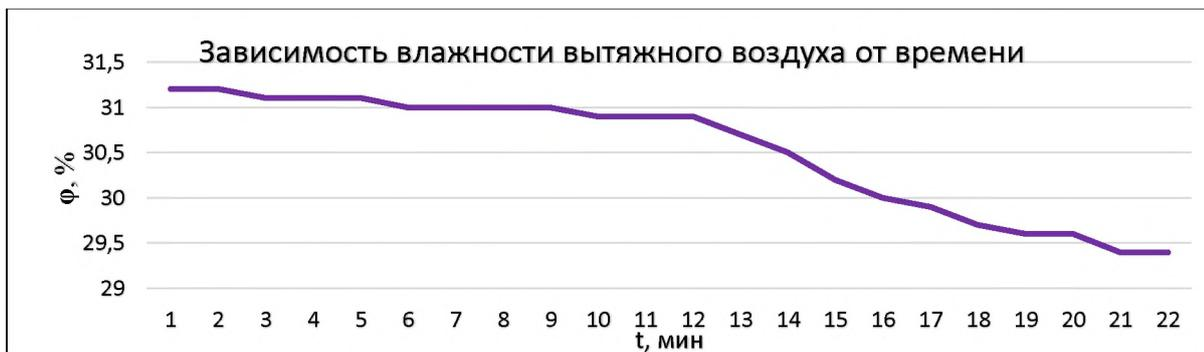
Рисунок 7. График зависимости влажности вытяжного воздуха от времени
