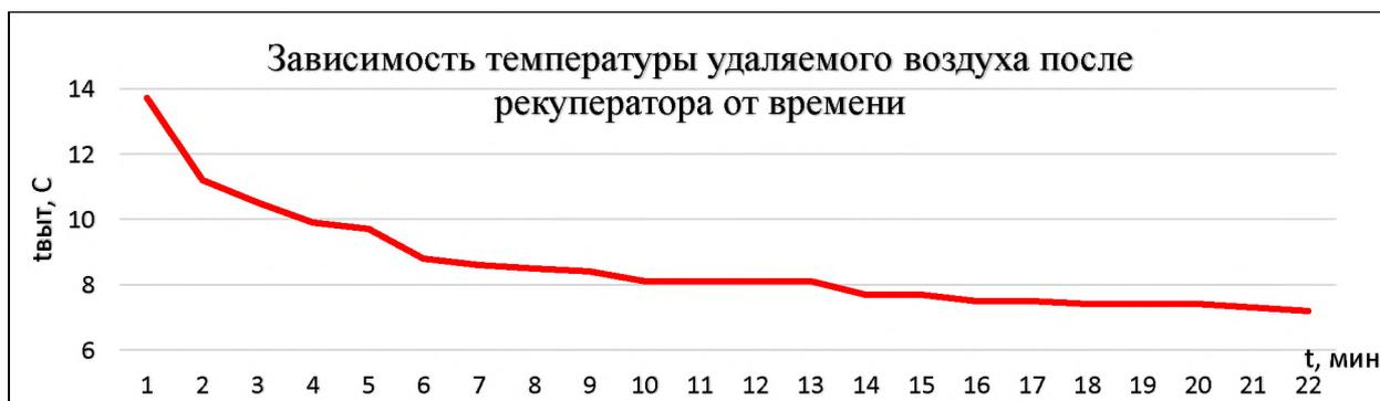
Рисунок 3. График зависимости температуры удаляемого воздуха после рекуператора от времени
