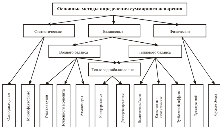
Рис. 1.15. Граф-схема основных методов определения суммарного испарения
