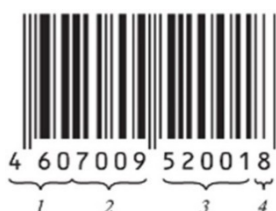
Рисунок 13 – Расшифровка штрихкода EAN-13:
