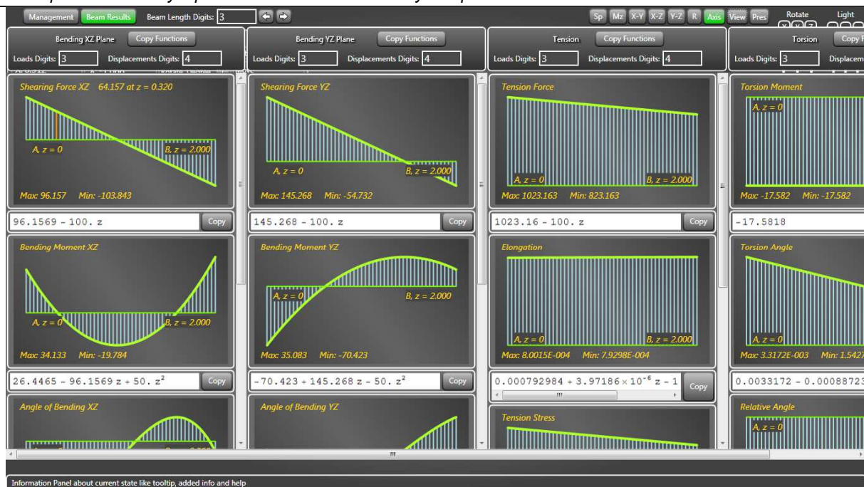
Рис. 3. Внутренние силовые факторы в первом стержне пояса по рисунку 1. Авторское экспериментальное программное обеспечение
