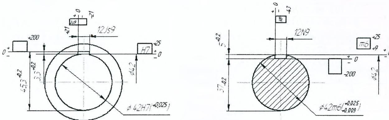
Рисунок 16 – Схемы расположения полей допусков шпоночного соединения
