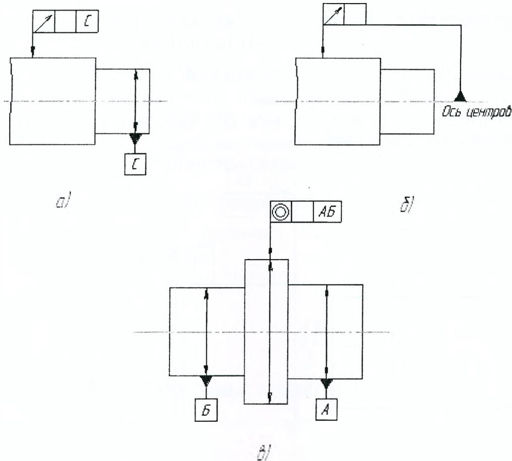
Рисунок 14 – Нанесение баз и допусков расположения:
