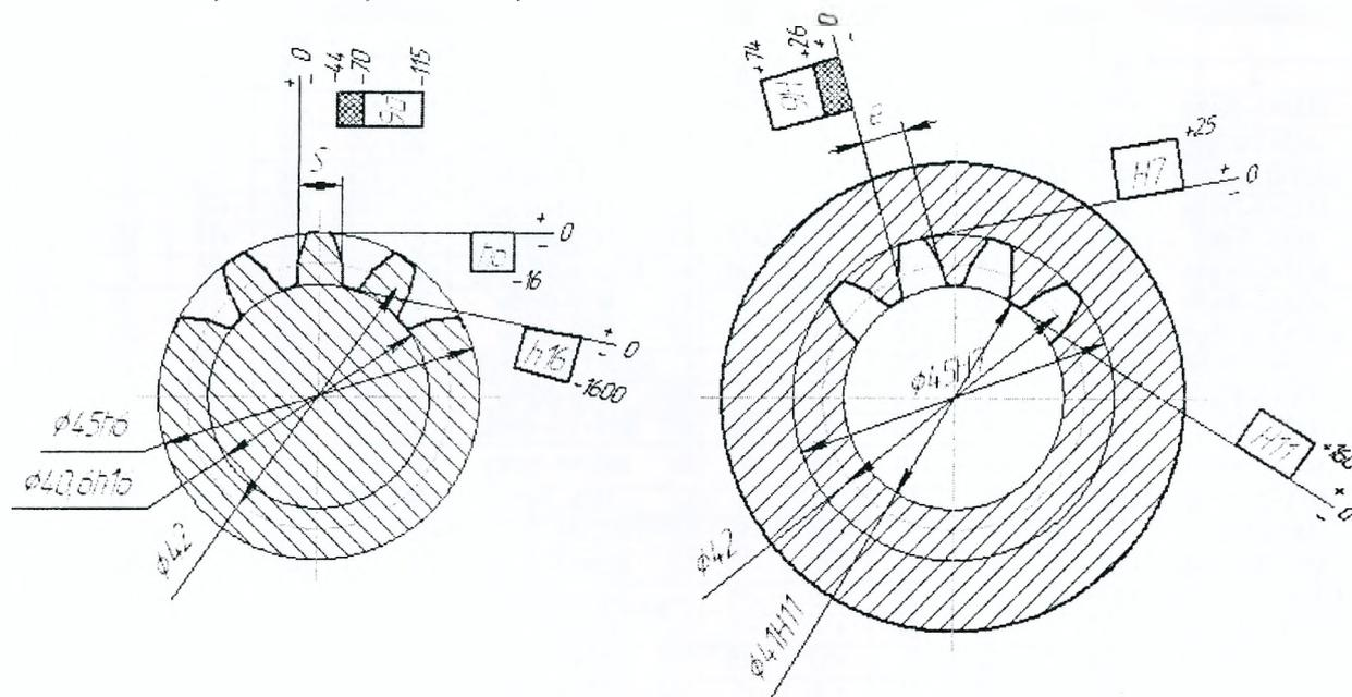
Рисунок 18 – Схемы расположения полей допусков эвольвентного шлицевого соединения
