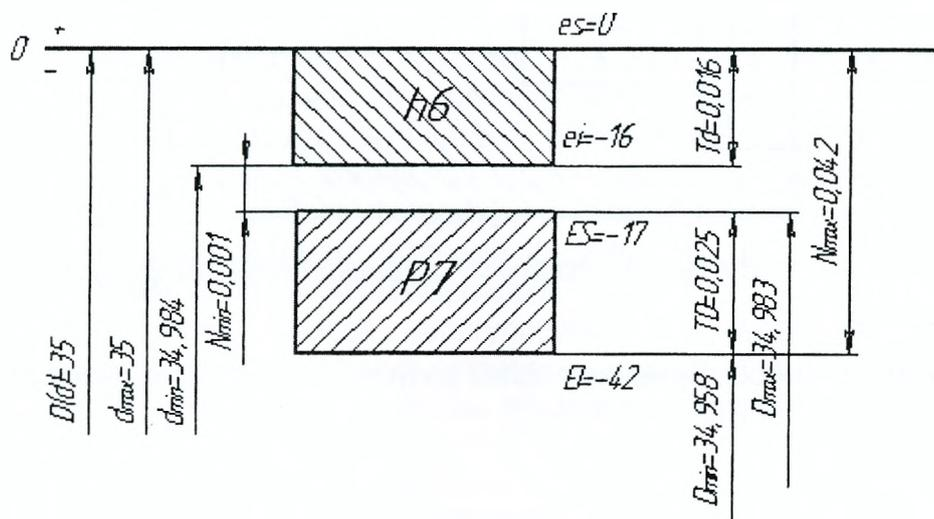
Рисунок 2 – Схема посадки с натягом  $\varnothing 35 \frac{P7}{h6}$
