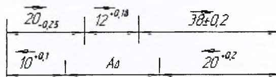
Рисунок 28 – Схема размерной цепи
