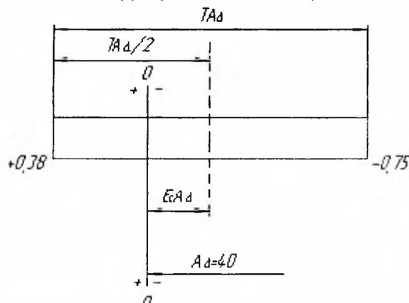
Рисунок 29 – Схема расположения поля допуска замыкающего звена
