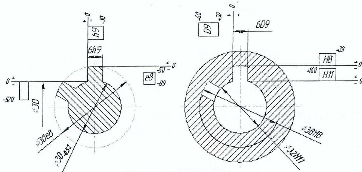
Рисунок 17 – Схемы расположения полей допусков прямобочного шлицевого соединения
