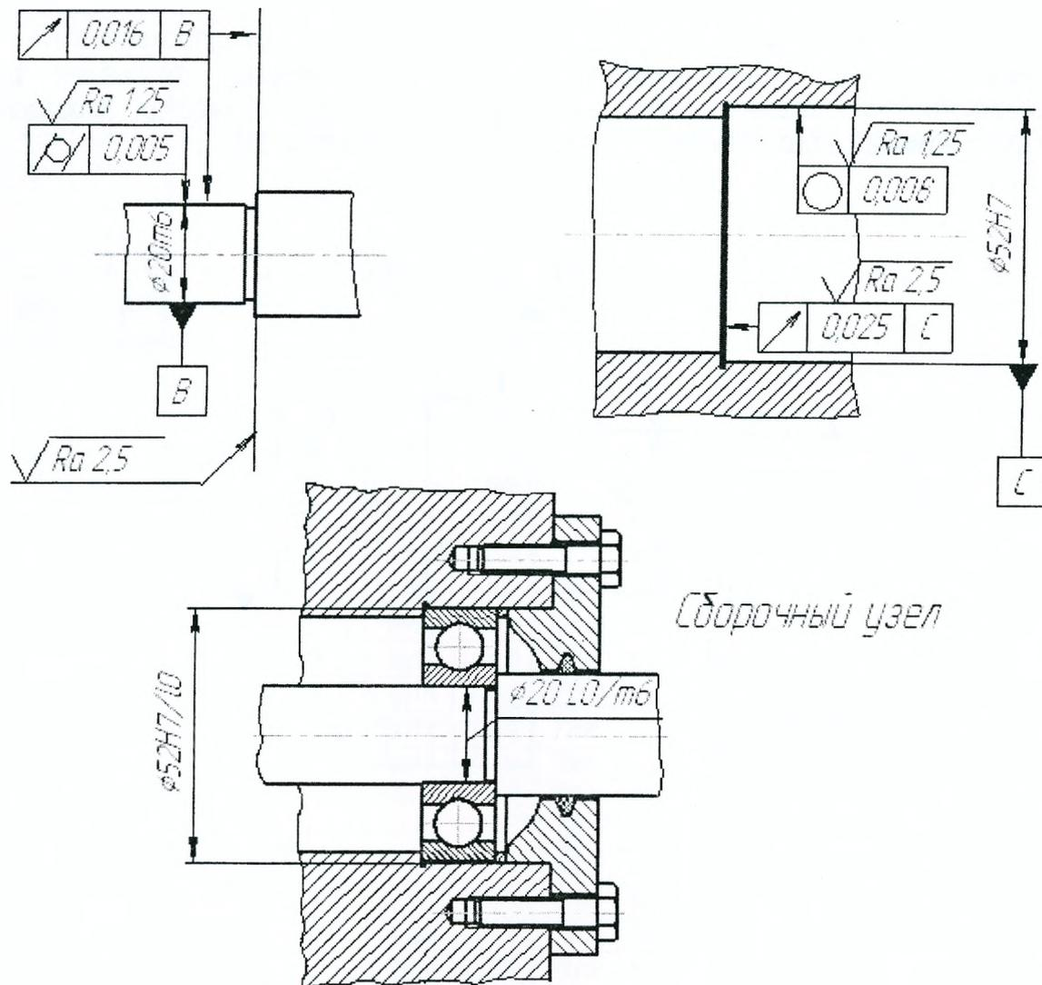
Рисунок 9 – Эскизы сопрягаемых деталей и сборочного узла ПК
