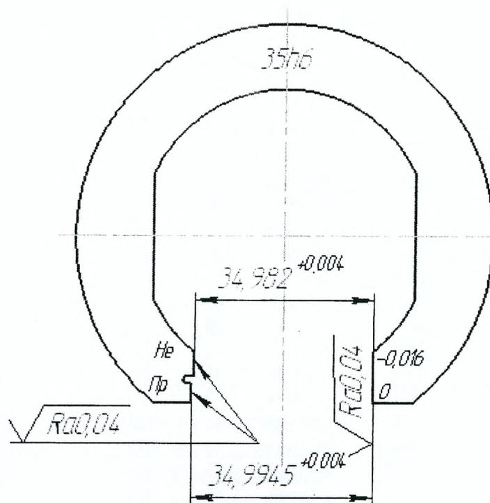
Рисунок 7 – Калибр-скоба для контроля вала  $\varnothing 35h6$
