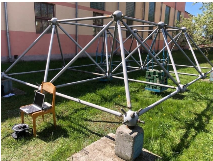
Рисунок 2 – Фрагмент структурной конструкции системы «БрГТУ» с подвешенным грузом
