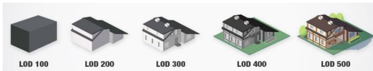
Рисунок 2 – Различные уровни проработки информационной модели [5]
