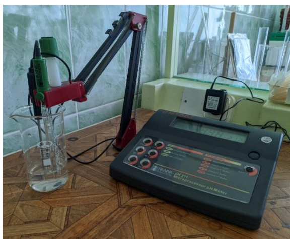
Рисунок 2 – Определение рН в водных вытяжках
