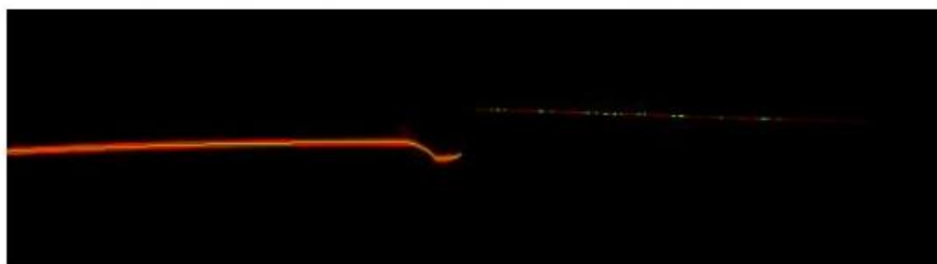
При малом времени экспозиции профиль светлого объекта выделяется корректно, на черном объекте выделяются только несколько точек профиля.
