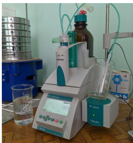
Рисунок 1 – Определение ионов хлора в водных вытяжках
