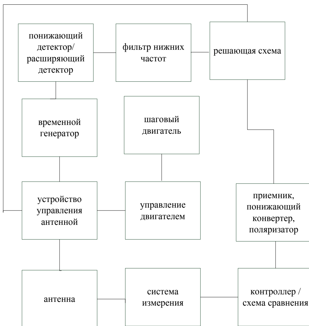
Рисунок 2 – Структура контроллера антенны
