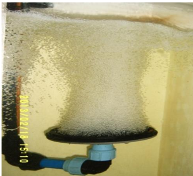
Рисунок 7 – Аэрация воды аэратором конструкции БрГТУ на испытательном стенде
