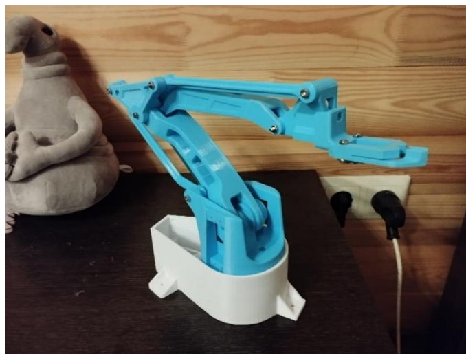
Рисунок 3 – имитационная модель робота-манипулятора в сборе
