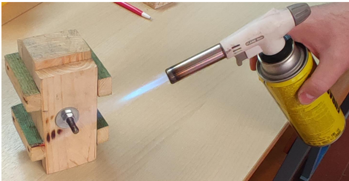
Рисунок 2 – Локальное воздействие высокой температуры на шпильки
