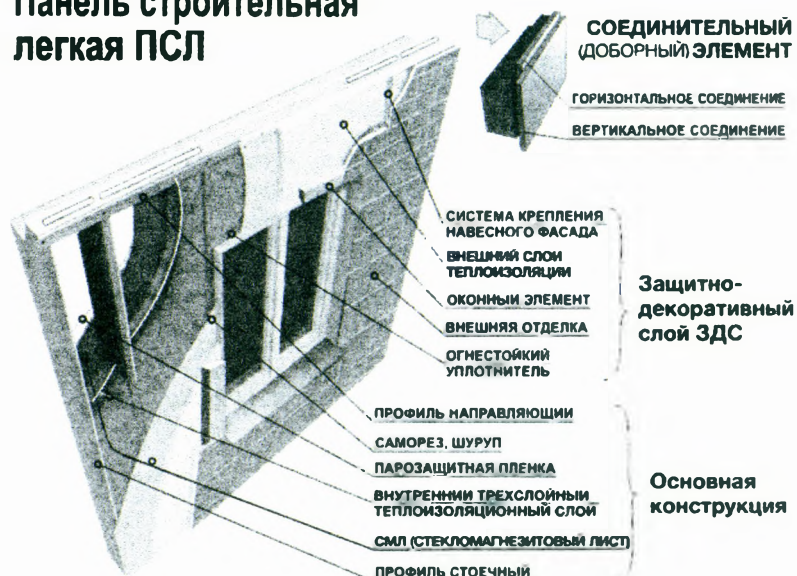
Рисунок 3 – Схема конструкции панели ПСЛ
