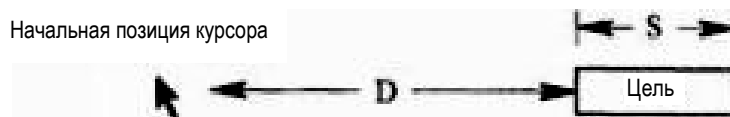
Рисунок 1 – Расстояния, которые используются в законе Фитса для определения времени, необходимого для перемещения курсора к цели
