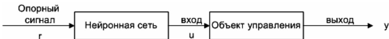
Рисунок 1 – Последовательная схема нейронного управления
