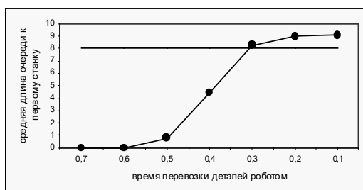
Рисунок 3 – Зависимость изменения средней длины очереди к первому станку от изменения времени перевозок деталей роботом
