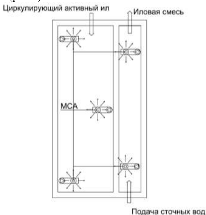
Рисунок 1 – Технологическая схема контактно-стабилизационного аэротенка
