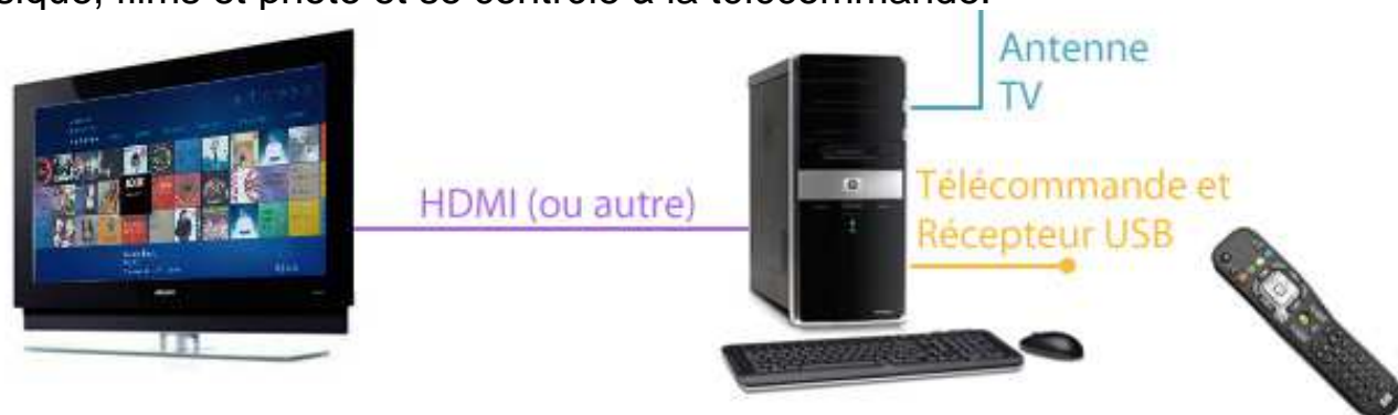
Schéma de branchement d'un PC Médiacenter dans votre salon
