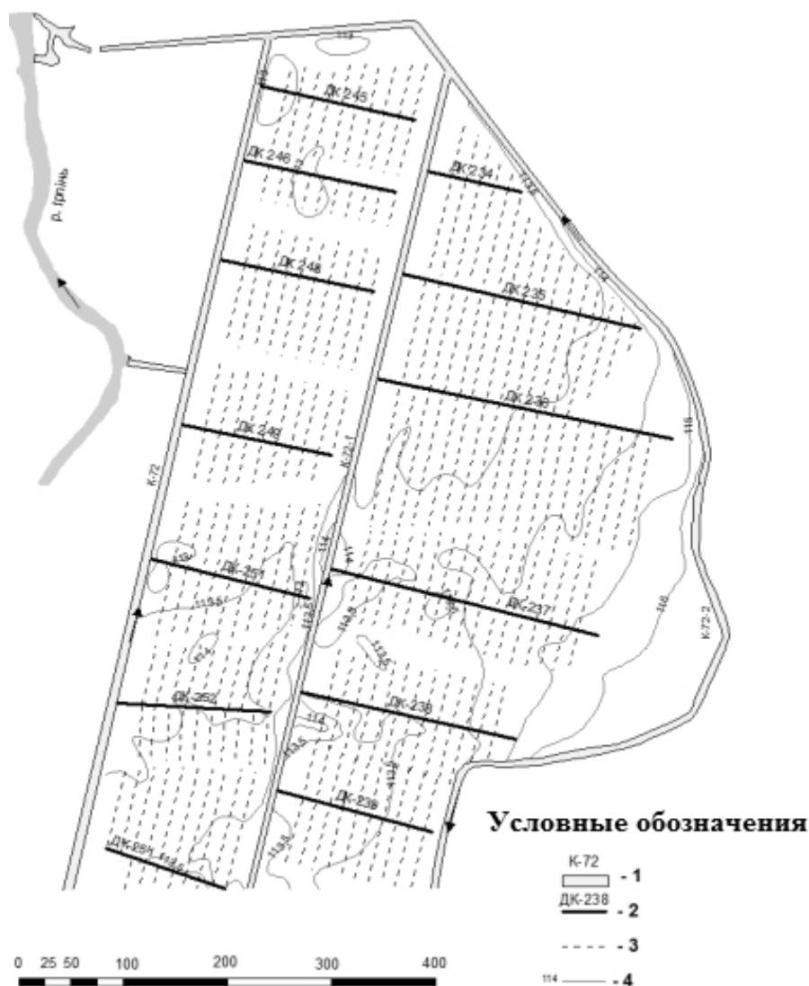
Рис. 26.5. Схема размещения закрытого горизонтального дренажа на участке Ирпенской ОУС, подвергшейся воздействию торфяного пожара в октябре 2015 г.:
