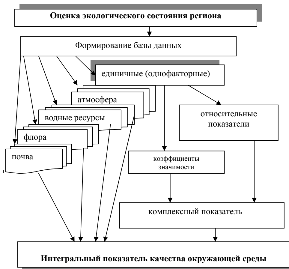
Рис. 21.4. Алгоритм определения интегрального показателя качества среды
