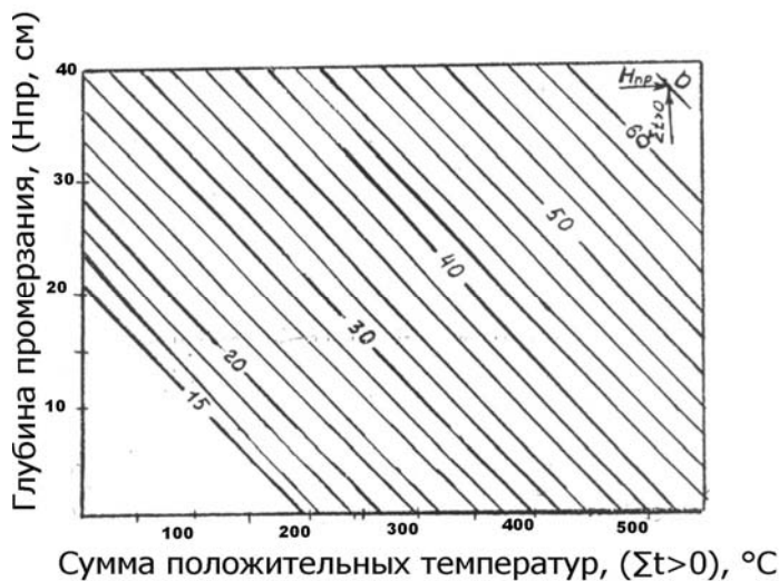
Рис. 3.4. Номограмма определения периода оттаивания ( D ) в днях по глубине промерзания почвы и суммой положительных температур воздуха
