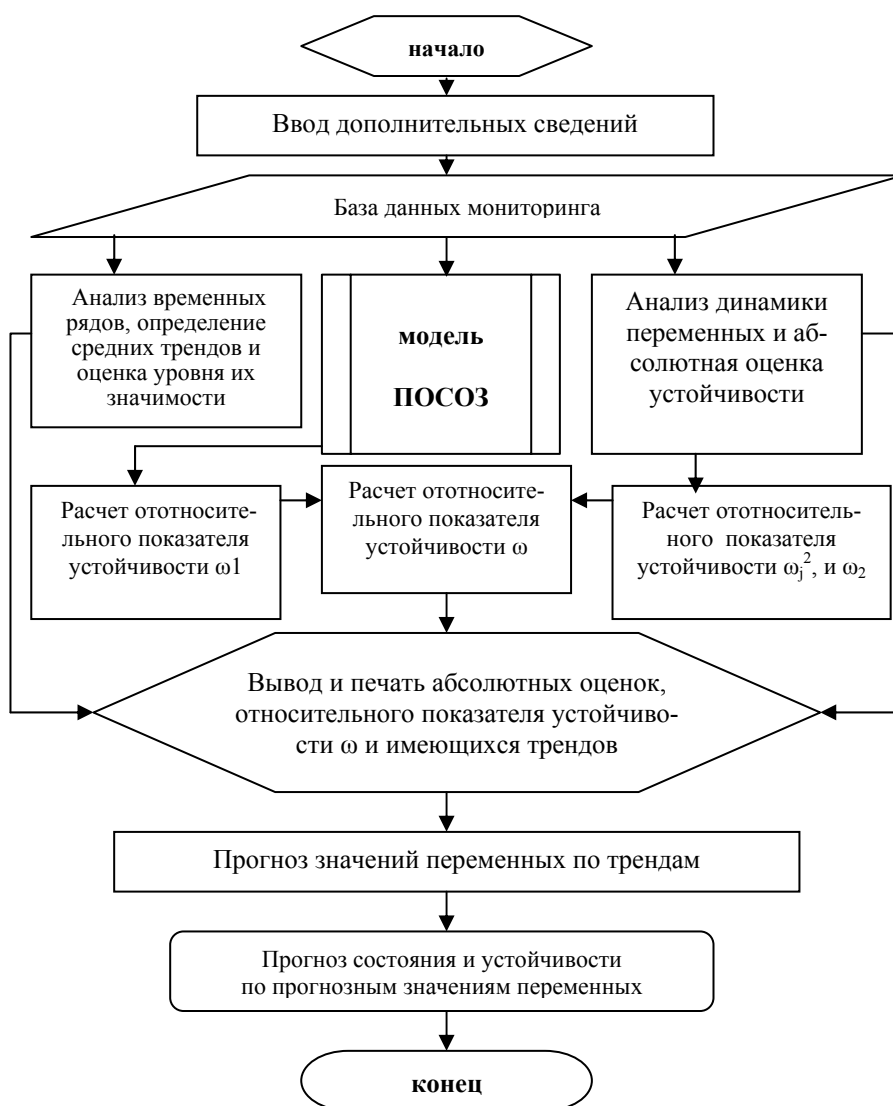
Рис. 14.4. Обобщенная блок-схема работы модели оценки устойчивости осушаемых земель
