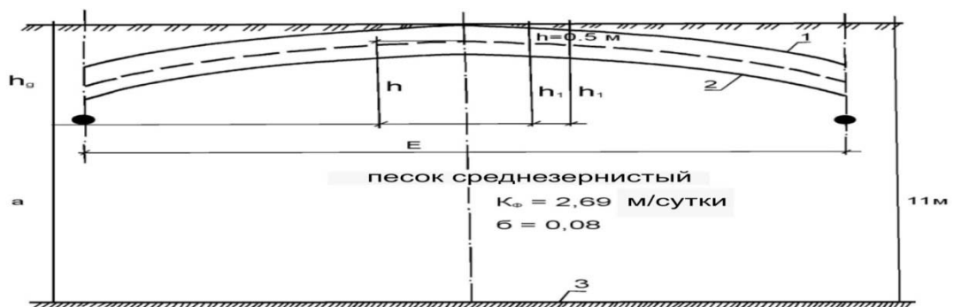
Рис. 14.15. Схема расчета расстояния между дренами
