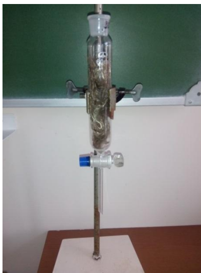
Рис. 1. Установка для исследования адсорбционной способности базальтовой фибры
