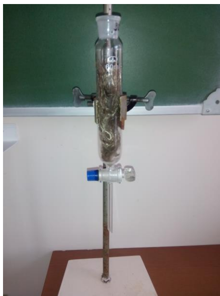
Рисунок 1. Установка для исследования адсорбционной способности базальтовой фибры
