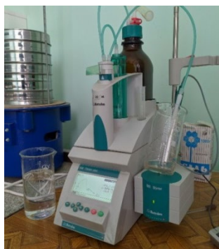
Рисунок 1 – Определение ионов хлора в водных вытяжках
