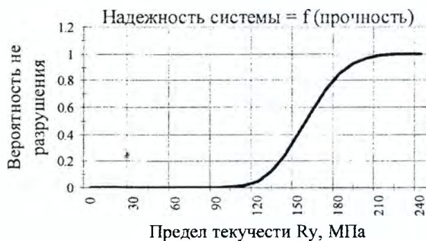
Рисунок 3 – Зависимость надежности системы от предела текучести R_y
