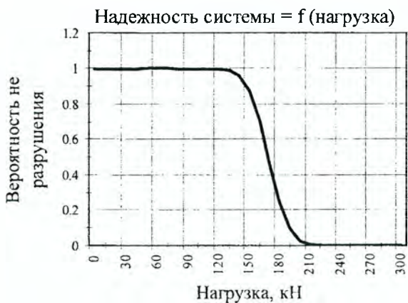
Рисунок 2 – Зависимость надежности системы от внешней нагрузки
