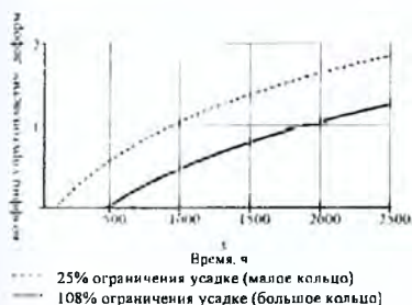
Рисунок 7 – Изменение коэффициента упругопластических деформаций при усадке
