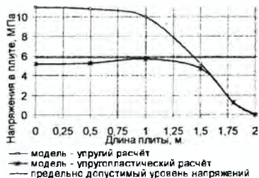
Рисунок 10 – Распределение напряжений по длине плиты (расчёт по блоку 2)
