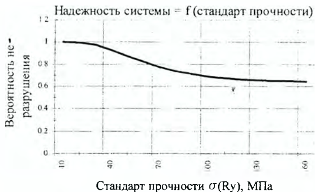
Рисунок 4 – Зависимость надежности системы от стандарта \sigma(R_y)
