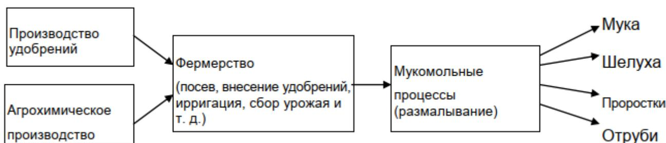
Рисунок 5.1 – Процесс производства муки
