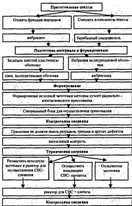
Рисунок 2 – Технологическая схема метода СВС – процесса
