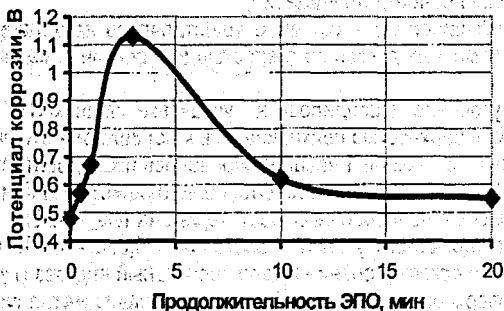
Рисунок 4 - Влияние ЭПО на изменение коррозионной стойкости поверхностного слоя.
