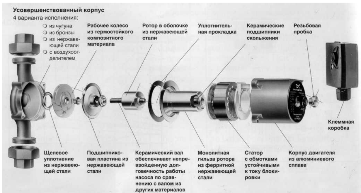
Рис. 5 Устройство насоса UPS с мокрым ротором
