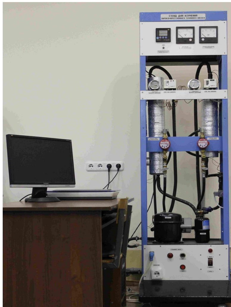
Рисунок 10 – Стенд «Тепловой насос»
