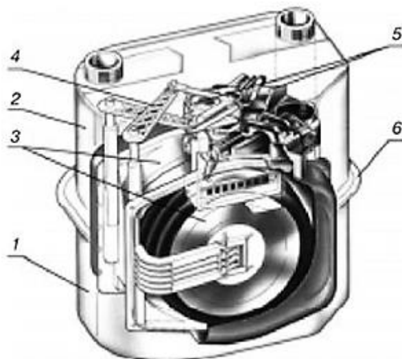
Рис. 6.1. Бытовой мембранный счетчик типа Г – 6: 1 — корпус; 2 — крышка; 3 — измерительный механизм; 4 — кривошипно-рычажный механизм; 5 — верхние клапаны газораспределительного устройства; 6 — стяжная полоса
