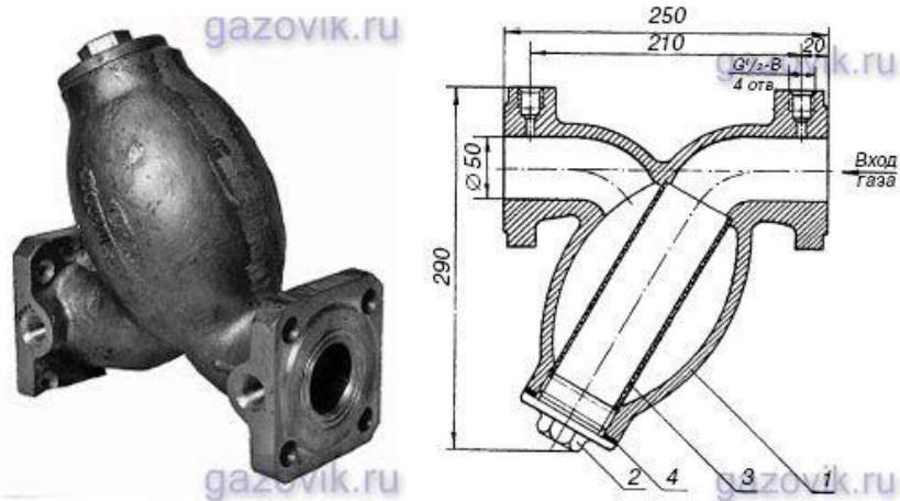
Рис.12.1. Фильтр газовый ФГ-50С: 1 — корпус; 2 — крышка; 3 — патрон с фильтрующей сеткой; 4 — прокладка
