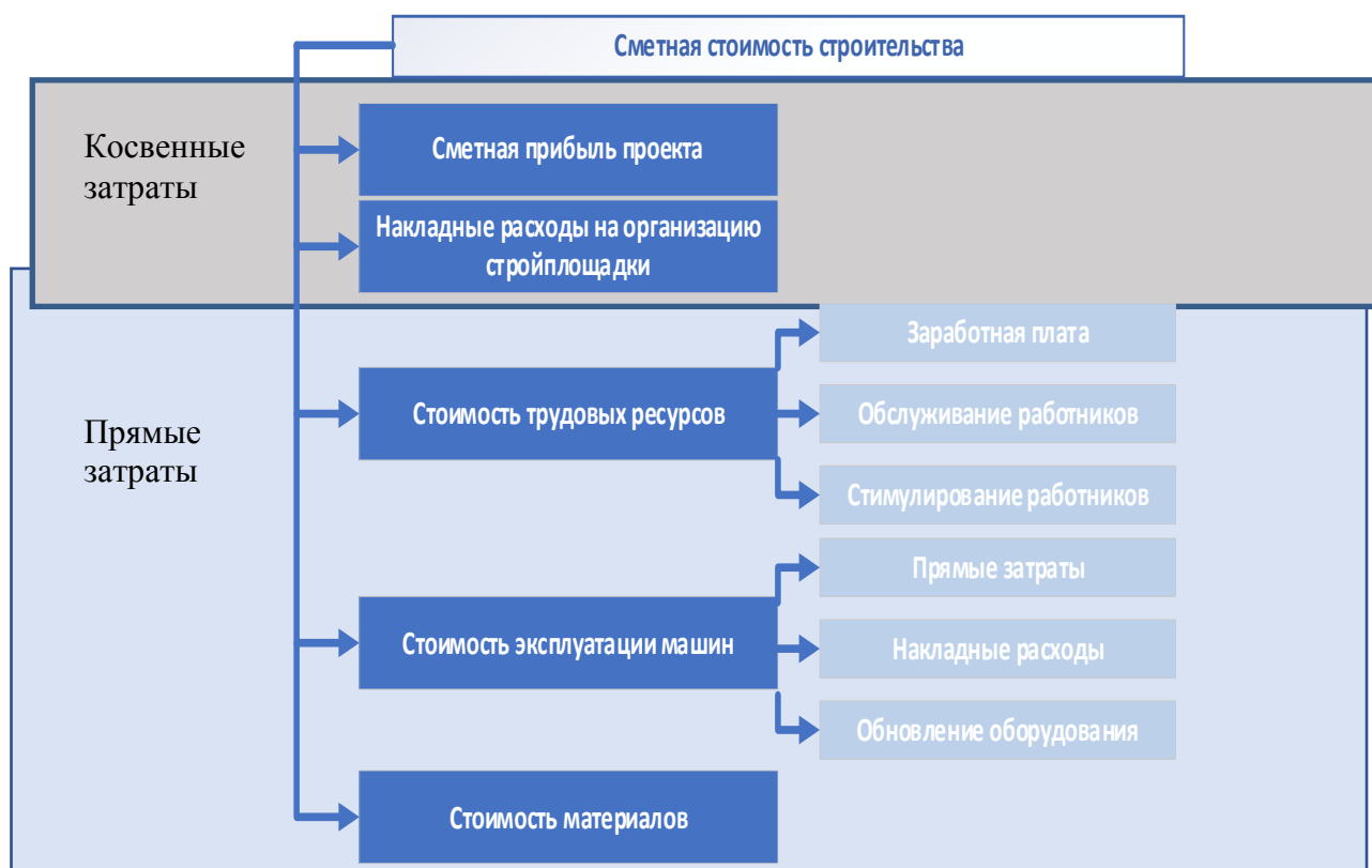
Рисунок – Система группировки сметных нормативов прямых и косвенных затрат в сметной стоимости строительства
