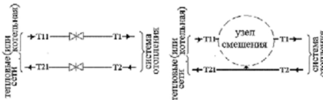
Узел смешения - элемент теплового узла, предназначенный для смешивания потоков различной температуры с целью регулирования температуры суммарного потока теплоносителя. Большинство зданий в РБ присоединены именно по зависимой схеме со смешением. Узлы смешения бывают со смесительным насосом; с циркуляционным насосом; с гидравлическим разделителем; с гидроэлеватором.
