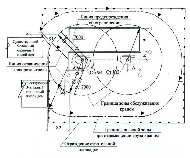
Стреловые краны для предотвращения столкновений с препятствиями при стесненных услловиях работы оснащаются системой координатной защиты. Лучи ограничения поворота стрелы крана должны быть привязаны при помощи координат:
