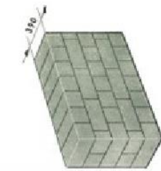
Из бетонных сплошных камней [толщиной 190 мм]
