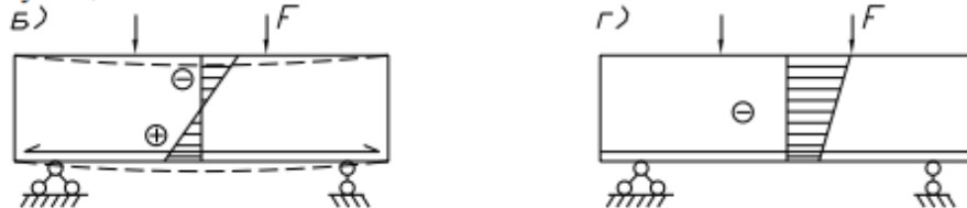
Рисунок 12.1. Распределение напряжений в балке с обычной арматурой (а, б) и с преднапряженной арматурой (в, г).
