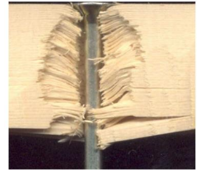
Рис. - Общий вид разрушения древесины под головкой винта (гвоздя)
