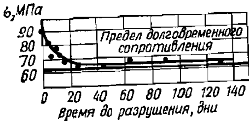
Рис. 1 – Кривая длительного сопротивления древесины по данным Ф.П. Белянкина
