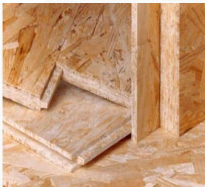
Рис. 1 - Общий вид слоев ОСП и обработки кромок
