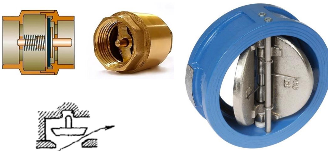
Принципиальная схема действия обратного клапана
