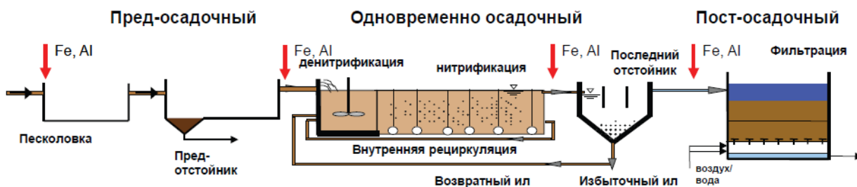
Рисунок 2 - Различные методы осаждения
