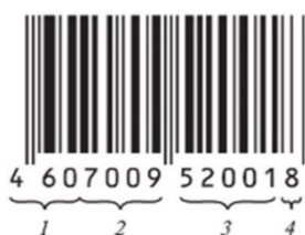
Рисунок 13 – Расшифровка штрихкода EAN-13:
