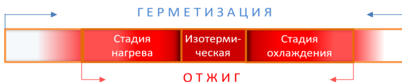
Рисунок 2 – Схема совмещения герметизации и отжига ШД
