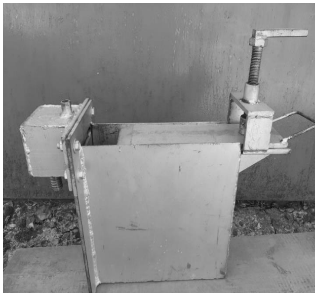
Рисунок 2 — Установка для аэродинамического звукового воздействия
