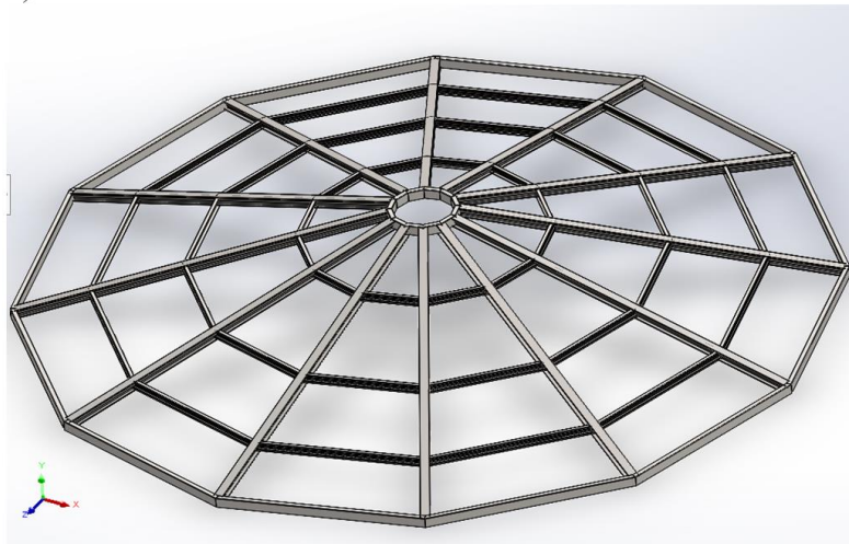
а – твердотельная параметрическая модель купола, б – эскиз поперечного сечения профиля несущего ребра Рисунок 1 – Ребристо-кольцевой купол
