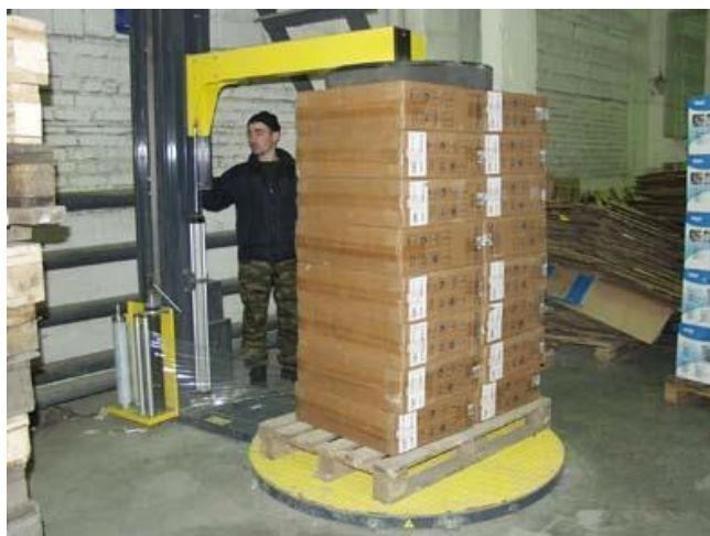
Рисунок 17 – Полуавтоматическая упаковка пакета сирейч-плёнкой
