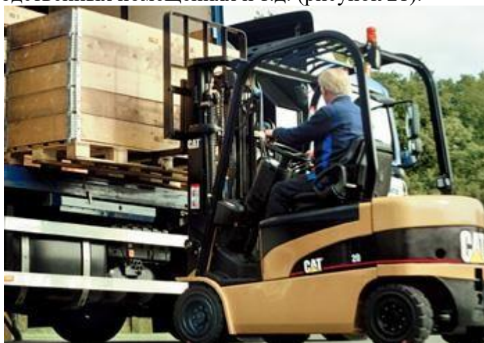
Рисунок 21 – Погрузка ящичных поддонов вилочным электропогрузчиком
