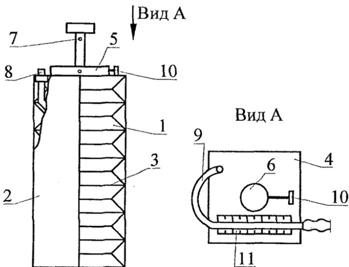
Рисунок 4.1 Газоанализатор типа УГ-2.
