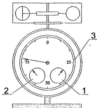
Рисунок 5.2. Анемометр чашечный.
