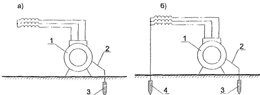
Рисунок 6.1. Принципиальные схемы защитного заземления:
