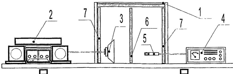
Рисунок 1.2. Схема лабораторной установки для исследования производственного шума.
