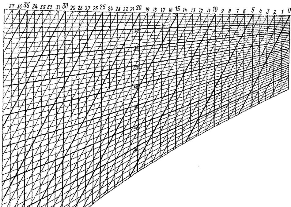
Рисунок 5.4. Номограмма для определения относительной влажности.
