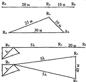
Рисунок 6.2. Наименьшие расстояния между заземлителем, вспомогательным заземлителем и зондом.
